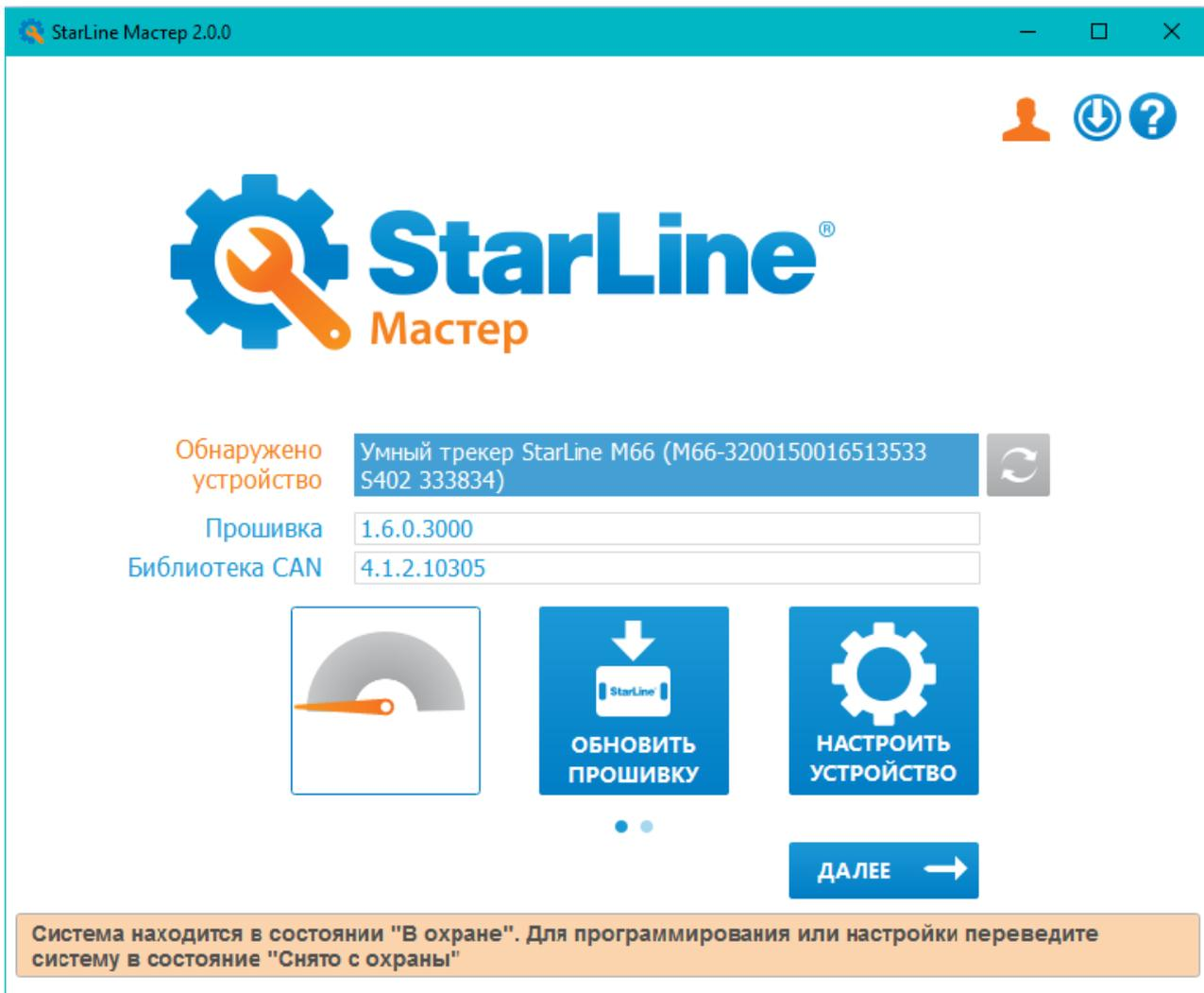
Для удобства настройки при установке трекера допускается повторный вход в режим настроек из любого состояния, если с момента последнего входа в настройки прошло не более одного часа или кабель USB не отключался.
